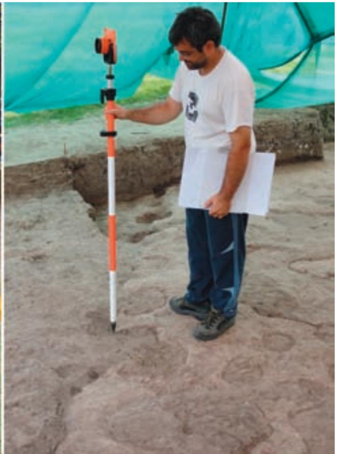
*Detalle de la toma de puntos con estación total para la materialización del dibujo de una de las fases de la excavación. Fuente: Azkárte et al 2012*
