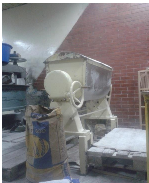
Ilustración 7: Mezcladora- Fuente: POPE, 2016.
