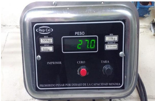
Ilustración 13 Control de ingreso de Cemento a Mezcladora.
