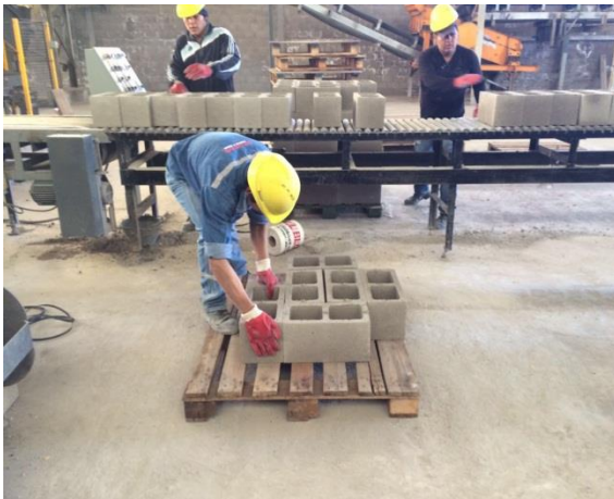
Ilustración 17 Armado de pallet.
