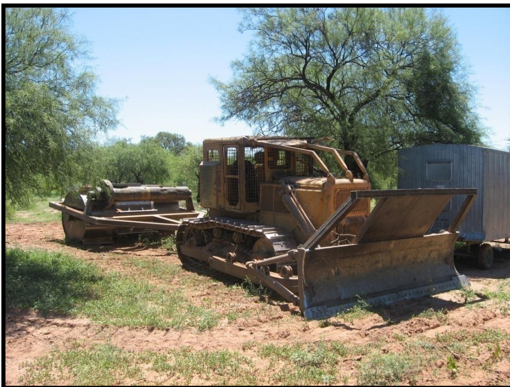
Topadora D7 con Pala 4 Mts ancho de trabajo y Rolo de 3 Mts ancho de trabajo con rodillo sembrador
