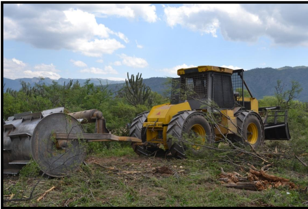
Tractor Pauny 540 equipado, con rolo de 3 mts. ancho de trabajo
