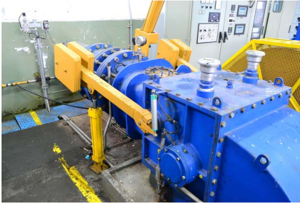
Ilustración 13: miniturbina de flujo cruzado con sus accionamientos
