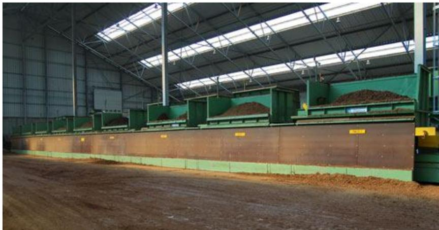
Manejo y transporte del material: Todo el movimiento del material se realiza por medio de cintas transportadoras de forma cóncava. Con el fin de contención lateral de la turba en estado fino.
