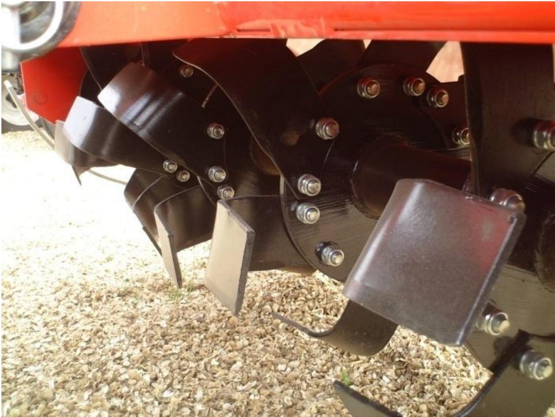
Vehículo de arrastre para rotocultor: Para este proceso según recomendación del fabricante en la labranza de tierra, no es necesario un tractor de mucha potencia, por lo tanto, se propone el uso de un tractor 4 x 4 de 35-40 hp,
