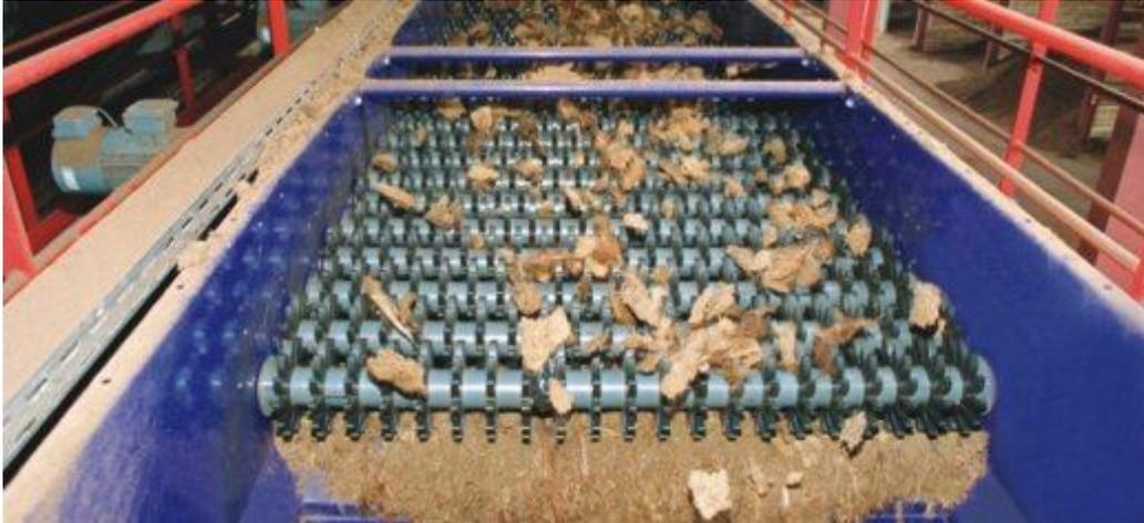
Según la malla del tamiz utilizada se obtienen diferentes granulometrías: 0-4 mm, 0-5 mm, 10-25 mm, 10-40 mm, 0-70 mm, 0-40 mm, 0-40 mm + fibra.
