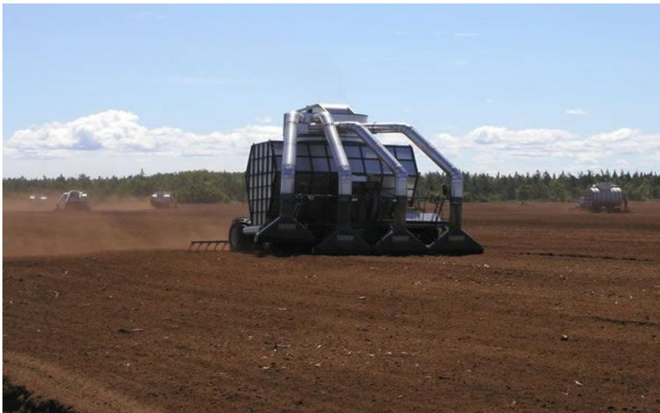
Las aspiradoras están compuestas por un tanque de almacenamiento con una capacidad de 20m<sup>3</sup> a 30m<sup>3</sup> aproximados.
