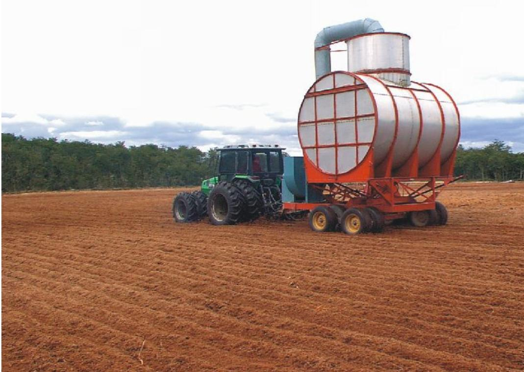
Capacidades: Varían de  $30\text{m}^3/\text{h}$  a  $50\text{m}^3/\text{h}$ . Según la cantidad de bocas, la potencia del tractor y el tamaño de sus conductos, puede almacenar hasta  $25\text{ m}^3$  de turba.
