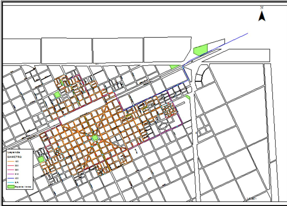
Fig30 Red colectora con sus Diámetros -8shape)
