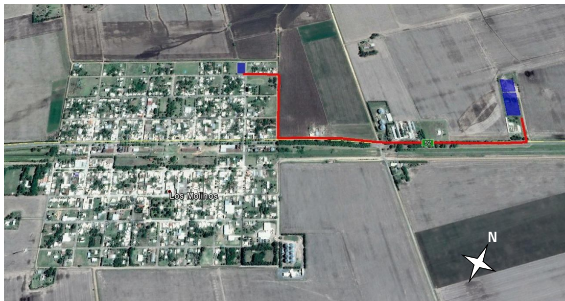
Figura IV.1. Trazo de la cañería de Impulsión desde la EE hasta la planta de tratamiento.
