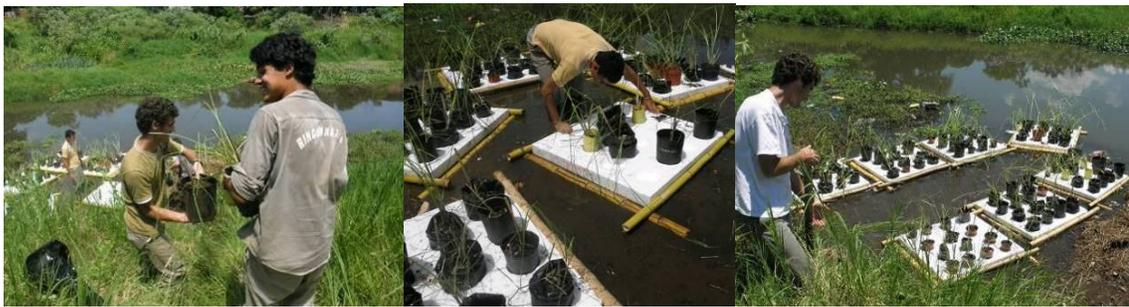
Disposición final de las bandejas flotantes del Sistema Vetiver. Una vez que las raíces se hayan desarrollado, periódicamente se tomarán muestras de agua de la parte exterior de la "V" para compararlas con las del interior.
