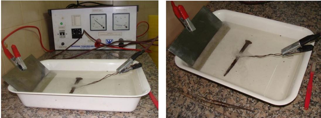
**Fotos 24 y 25: En el electrodo positivo se coloca una chapa de acero donde se van pegando las impurezas del metal tratado y en el negativo se coloca la pieza arqueológica**
