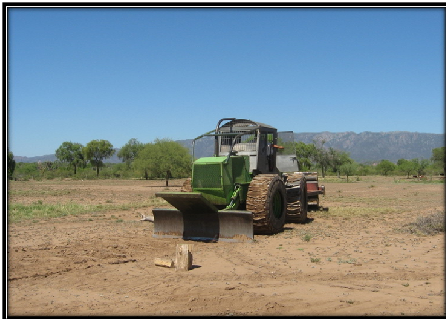
Tractor Pauny 500 equipado, con rolo de 3 mts. ancho de trabajo
