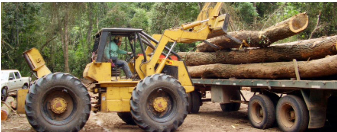
Carga de rollos utilizando pala del skidder (E. Balducci)
