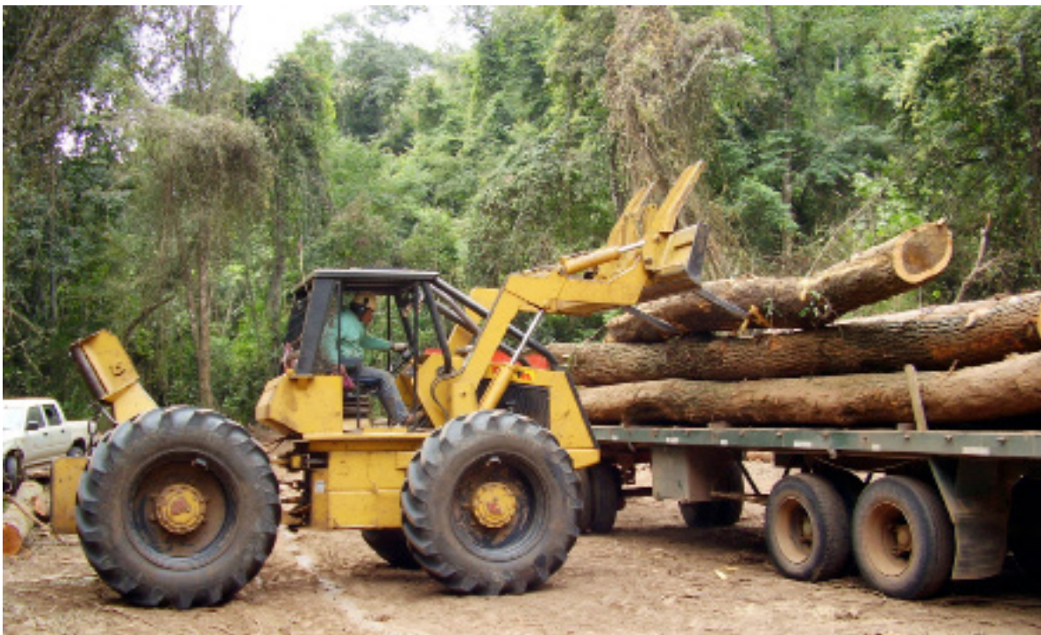
Carga de rollos utilizando pala del skidder (E. Balducci)
