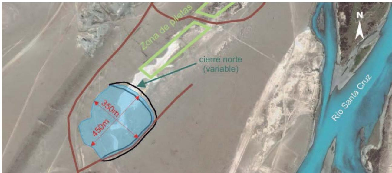
Figura 22 . Esquema de reservorio. Ubicación y dimensiones. (Fuente propia).
