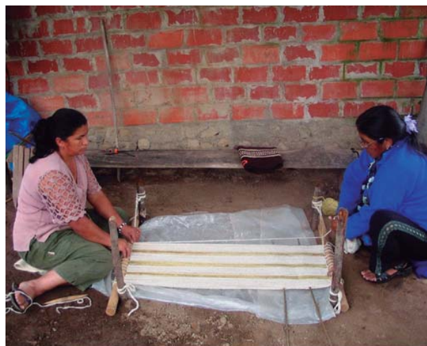
Artesanas realizando el urdido, en telar de estacas, para tejer el picote (Los Toldos, febrero de 2009).
