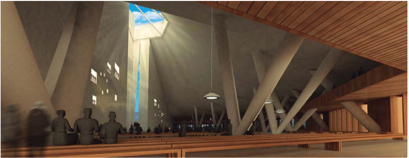
Desde el lucernario se dirigirán cenitalmente proyectores de haces concentrados con lámparas de descarga de mercurio de alta presión de 1000 W, con filtros dicróicos para tornar la luz cálida.
