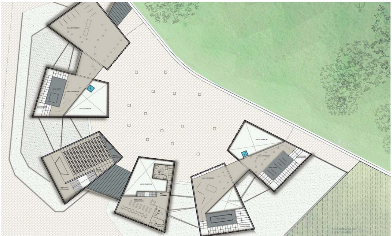
Niveles planta baja y planta alta. Consta de seis edificios de formas trapezoidales irregulares, en dos niveles. Su geometría independiente permite su individualidad y enfatiza su presencia.
