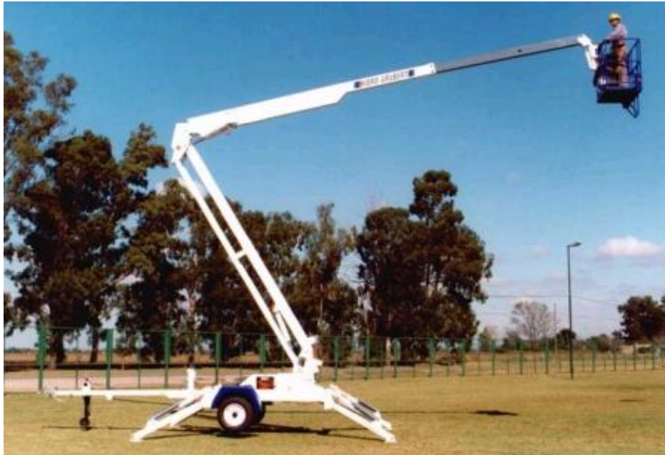
Figura N° 4: Elevador hidráulico con cesta articulada montado sobre un tráiler
