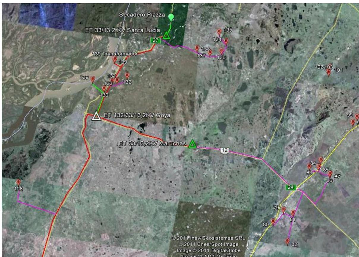
para dar confiabilidad al suministro y que este proyecto solo se pondrá en marcha una vez concluida la LMT 33kv Goya- Maruchas. El conductor a utilizar en concordancia con el tramo anterior es de 95 mm<sup>2</sup> de Al-Al y su tramo troncal tiene una longitud de 30km.
