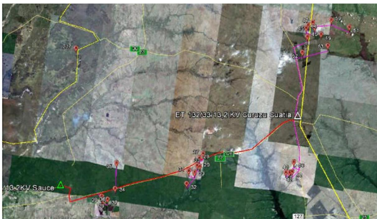
La línea de 33kv a construirse sobre Ruta Nacional N° 119 sur de una longitud aproximada de 20km. consiste en una simple terna de H°A° a conectarse desde una de la terna existente en la intersección de la Ruta Nac. 126 y 119. El conductor en concordancia con el existente será de 95mm<sup>2</sup> Al-Al. Los bombeos beneficiados con esta obra corresponden a 40 a 43.
