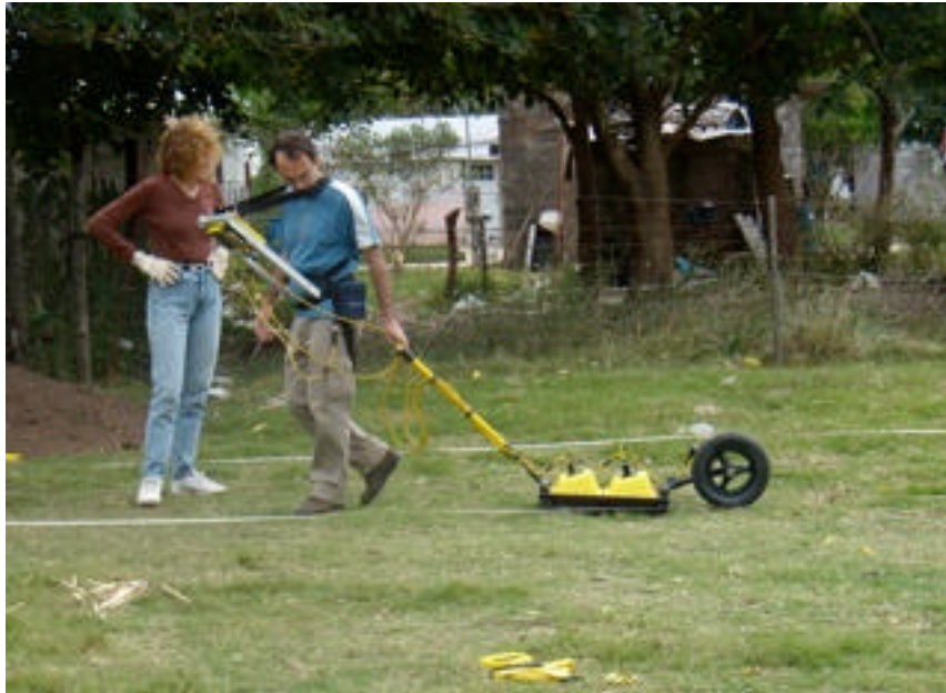
Foto 1: Relevamiento geofísico empleando el Método de Georadar
