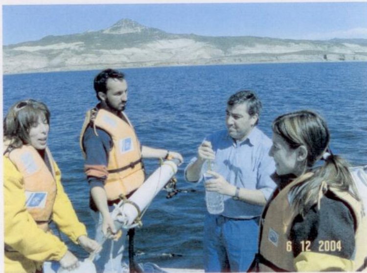
Equipo similar a la botella nansen usada para tomar una muestra representativa de la columna de agua
