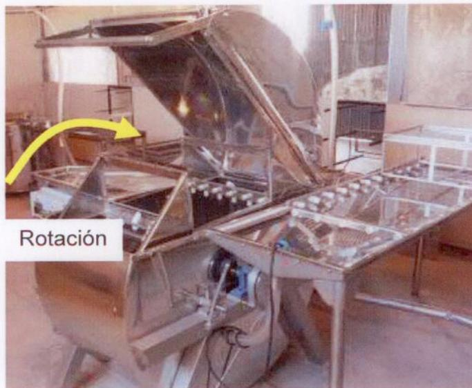
Se revisaron los extractores y se aconsejó que la rotación de los motores y canastos se realice a la inversa para evitar riesgos de aplastamiento de las manos en los momentos de que el operario que trabaje en el sector ayudando a girar al canasto. Alguna de las bajadas de luz (cables) para la alimentación de los extractores, estaban situadas en lugares de tránsito, lo cual es perjudicial para un buen trabajo y peligroso para los operarios, éstas deberán ser colocadas en otro lugar.
