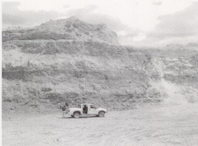
Imagen 3. Imagen del frente de explotación del yacimiento Mercedes II, uno de los incluidos en este Informe. En el perfil expuesto se puede ver por encima las areniscas intermedias, y por debajo los bancos de arcillas para uso cerámicos
