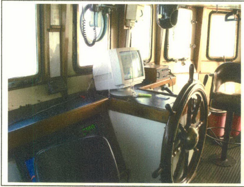
Figura 4.- Monitor repetidor del programa de navegación para el seguimiento de la prospección geofísica.
