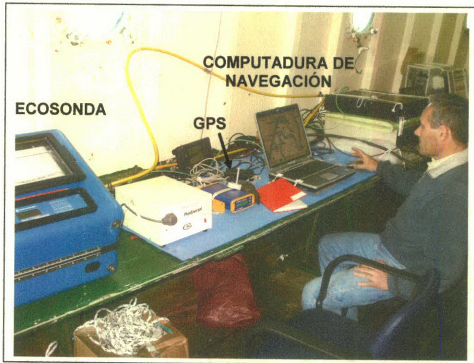
Figura 3.- Sistema de navegación y batimetría conformado por computadora con programa de navegación y adquisición de datos batimétricos y de latitud-longitud, GPS y ecosonda analógica-digital.
