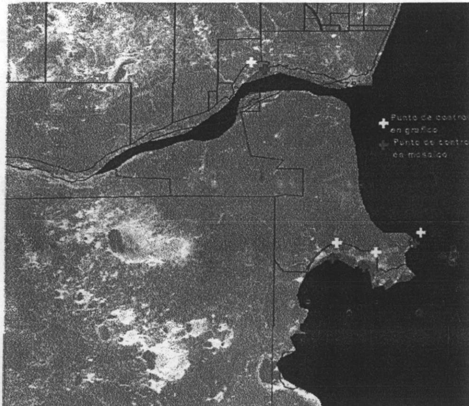
Figura 6: Georreferenciación mediante puntos de control
