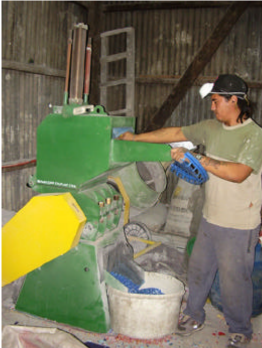
Moliendo el polipropileno de un color
