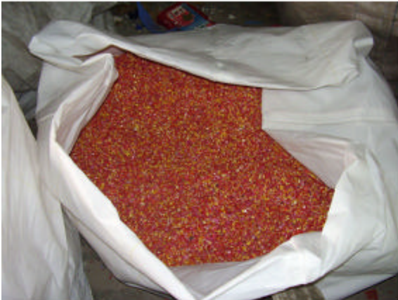
Polipropileno clasificado por tono molido
