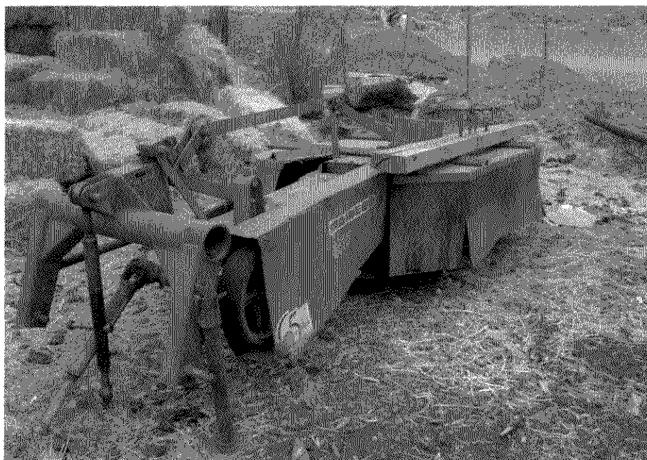
1 CORTADORA ROTATIVA A TAMBORES MAINERO 6015. Cuchillas flotantes reversibles. Ancho de corte: 1,65 m. Acople montada en tres puntos. La transmisión se realiza desde la toma de potencia del tractor mediante una correa. No tiene rodillos acondicionadores del forraje.
