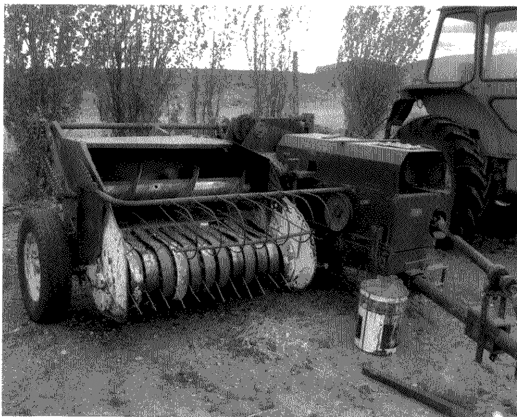
1 ENFARADORA. Vinculada mediante lanza de tiro, accionada por la toma de potencia del tractor. Atado mediante alambre.
