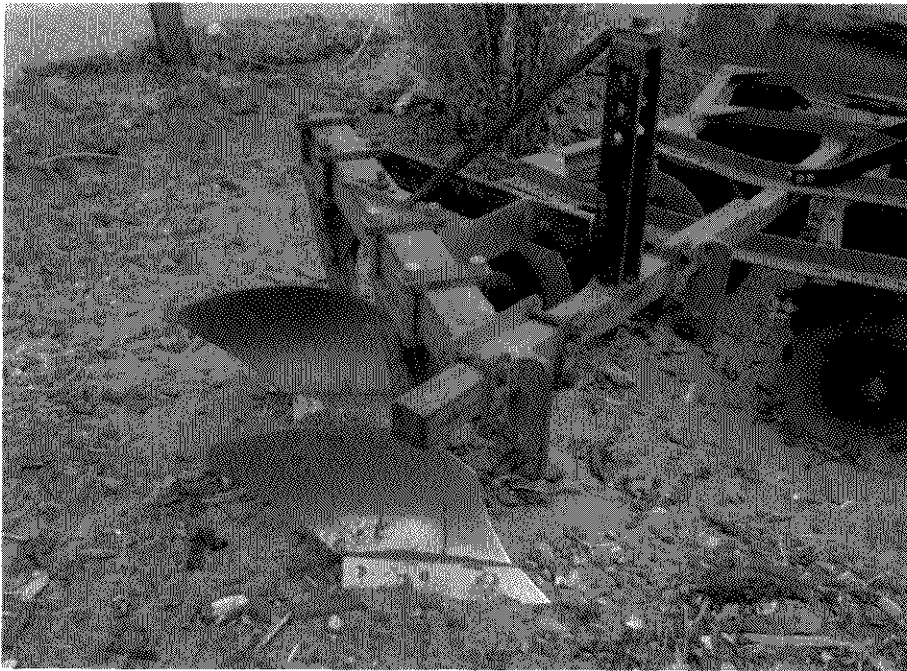
1 ARADO DE REJAS Y VERTEDERAS de 3 unidades funcionales de 14 pulgadas, montado en tres puntos. Le falta 1 reja y los tres discos cortadores de la gleba de suelo.
