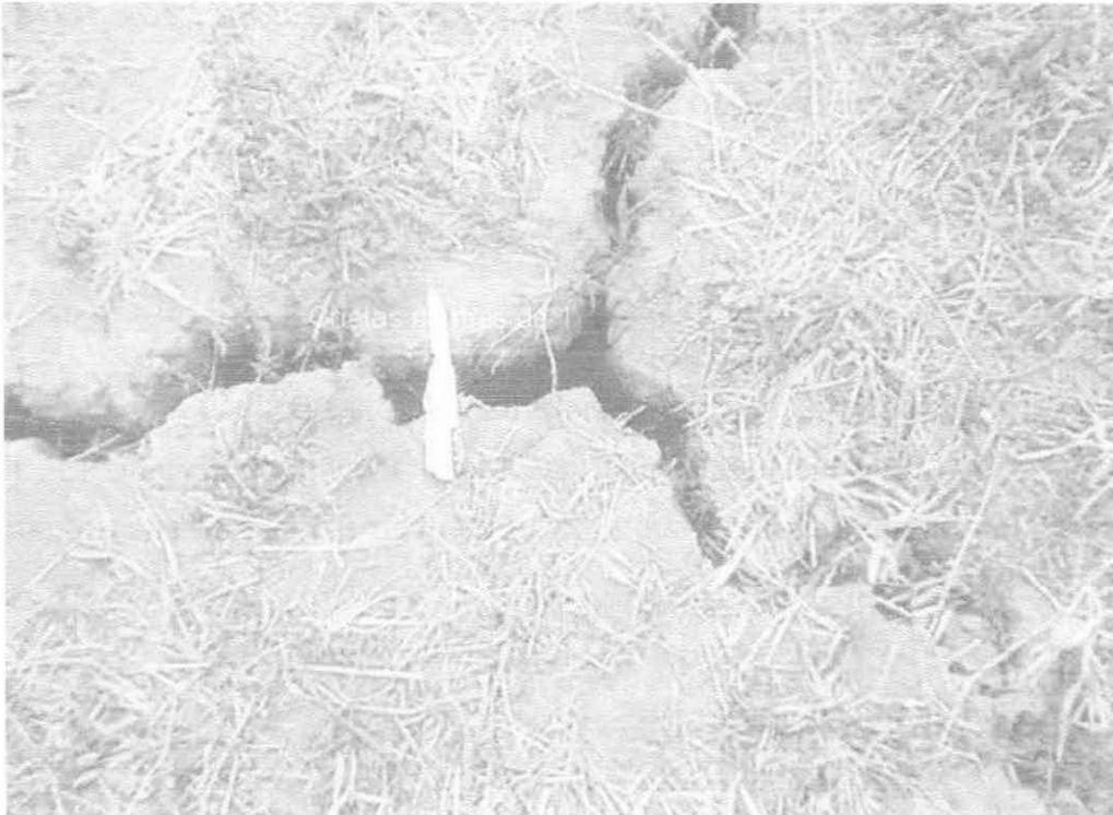
En un ensayo de Hinchamiento del suelo en laboratorio donde se compara el valor de máxima extensión que adquiere un suelo saturado con agua con el valor en seco se han obtenido valores que confirman el comportamiento de expansión para los suelos de estas unidades en comparación con los de las unidades Paleocauce y Paleoalbardón.
