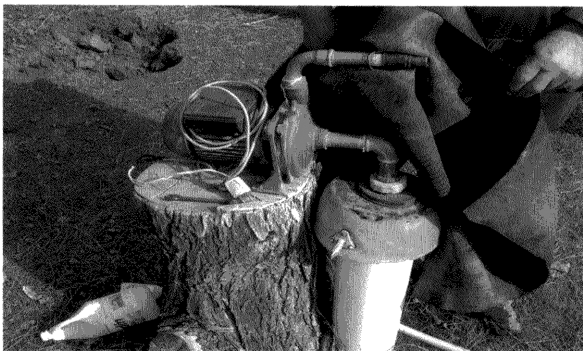
Foto N° 23: Vista de bomba de ½ HP, para riego de invernadero en Perito Moreno
