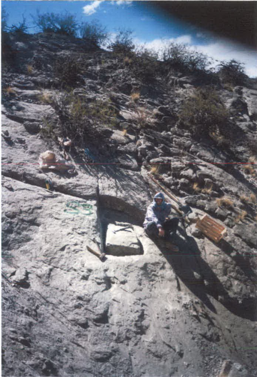
FOTO N° 20: SITIO 3. Toma de muestras indisturbadas.
