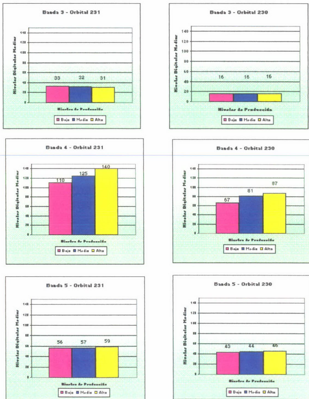
Figura 2: Comparación de los Niveles Digitales Medios para el cultivo de Caña de azúcar, zafra 2000
