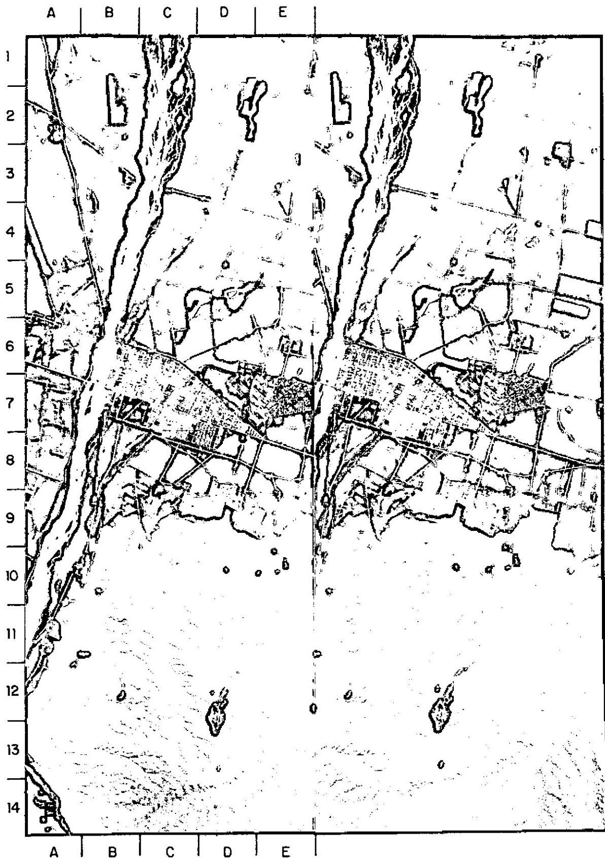
ESTEREOGRAMA N° 1: Localidad de LEDESMA, Prov. de Jujuy, vuelo de F.A.A. para el C.F.I., 12-01-90, escala aproximada 1:80000, corrida 1, par 4 y 5, focal calibrada 85,511 mm.
